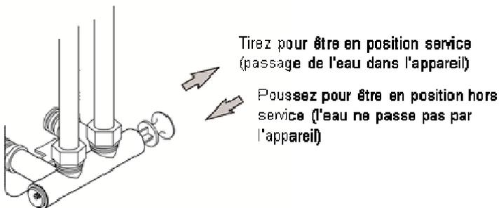
**IMPORTANT:** Utilisez les joints adéquats pour le raccordement de la plomberie sur le by-pass. Veillez à respecter l'entrée (IN) et la sortie (OUT) indiquées sur la tête de votre adoucisseur.
