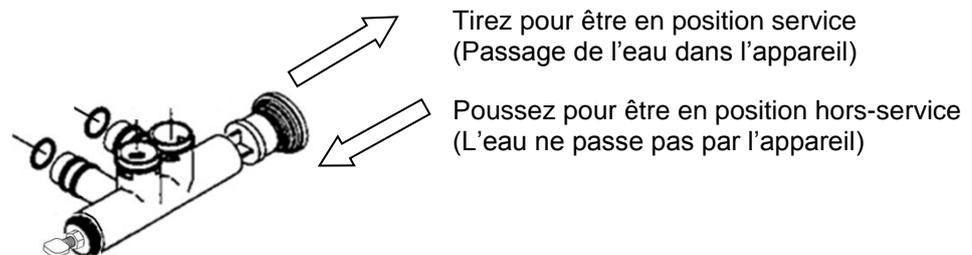
**IMPORTANT:** Utilisez les joints adéquats pour le raccordement de la plomberie sur le by-pass. Veillez à respecter l'entrée (IN) et la sortie (OUT) indiquées sur la tête de votre adoucisseur.
