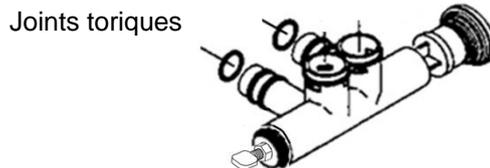
5. Insérer le by-pass dans la vanne par le haut ou par le bas en fonction de l'emplacement de l'arrivée d'eau.
