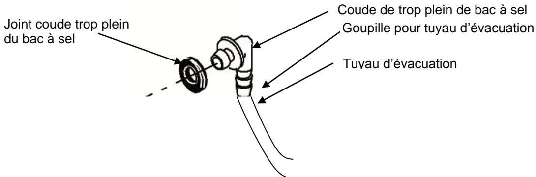
**NOTE:** L'évacuation se fait grâce à la gravité, le tuyau ne doit donc ne pas dépasser la hauteur du coude de trop plein lors de son raccordement à l'évacuation équipée d'un siphon.
