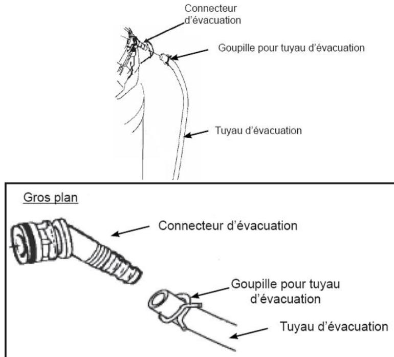
2. Raccordez le tuyau d'évacuation de régénération à une évacuation équipée d'un siphon (**cf. étape suivante**).
