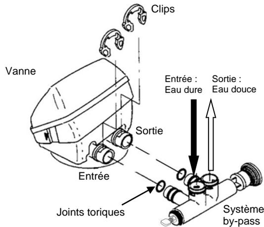
**NOTE:** L'entrée (IN) et la sortie (OUT) sont indiquées sur la tête. Assurez-vous de faire le bon raccordement (Eau à traiter à raccorder côté IN, eau vers la maison côté OUT).
